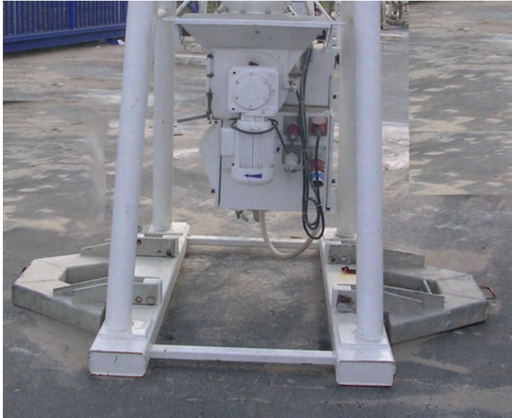
Bild 4: Verbreiterung der Aufstandsflächen zur Erhöhung der Standsicherheit
