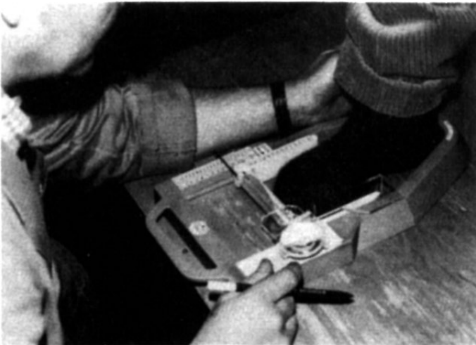
Bild 4: Vermessen des bekleideten Fußes nach Länge und größter Breite mit einem einfachen Messgerät
