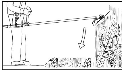
Zum Auslichten von Wildwuchs und Gestrüpp das Dickichtmesser von oben in die Pflanze "tauchen" – das Schneidgut wird gehäckselt – dabei das Schneidwerkzeug nicht über Hüfthöhe halten.
