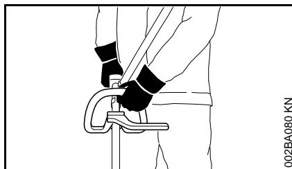
Bei Ausführungen mit Rundumgriff und Rundumgriff mit Bügel (Schrittbegrenzer) linke Hand am Rundumgriff, rechte Hand am Bedienungsgriff – auch bei Linkshändern.
