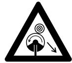
Beim Einsatz von Metall-Schneidwerkzeugen besteht die Gefahr des Rückschlags, wenn das Werkzeug auf ein festes Hindernis (Baumstamm, Ast, Baumstumpf, Stein oder dergleichen) trifft. Das Gerät wird dabei zurückgeschleudert – gegen die Drehrichtung des Werkzeuges.
