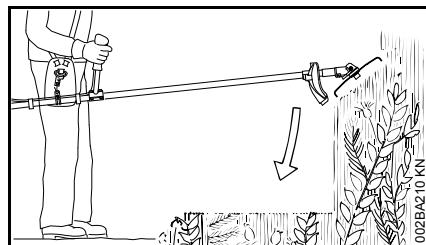
Zum Auslichten und Zerkleinern von Wildwuchs und Gestrüpp das Häckselmesser von oben in die Pflanze "tauchen" – das Schneidgut wird
