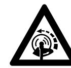
Motor nicht "aus der Hand" anwerfen – starten wie in der Gebrauchsanleitung beschrieben. Das Schneidwerkzeug läuft noch kurze Zeit weiter, wenn der Gashebel losgelassen wird – **Nachlaufeffekt!**
