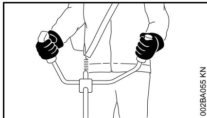
Rechte Hand am Bedienungsgriff, linke Hand am Griffrohr des Griffrohres.
