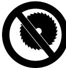
Niemals Kreissägeblätter, Hartmetall-, Bergungs-, Holzschnede- oder andere verzahnte Werkzeuge verwenden – **Gefahr tödlicher Verletzungen!** Im Gegensatz zum gleichmäßigen Abtragen von Partikeln bei Benutzung von Trennschleifscheiben, können die Zähne eines Kreissägeblattes beim Schneiden in den Werkstoff einhaken. Dies bewirkt ein aggressives Schneidverhalten und kann zu unkontrollierten, äußerst gefährlichen Reaktionskräften (Hochschlagen) des Gerätes führen.
