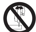
Trennschleifscheibe gerade im Schnittspalt führen, nicht verkanten oder einer Seitenbelastung aussetzen.
