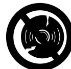
Trennschleifscheibe öfter prüfen – sofort ersetzen, wenn sich Risse, Wölbungen oder andere Schäden (z. B. Überhitzung) zeigen – durch Bruch **Unfallgefahr!**
