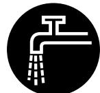
Trennschleifscheibe nur mit Wasser verwenden.
