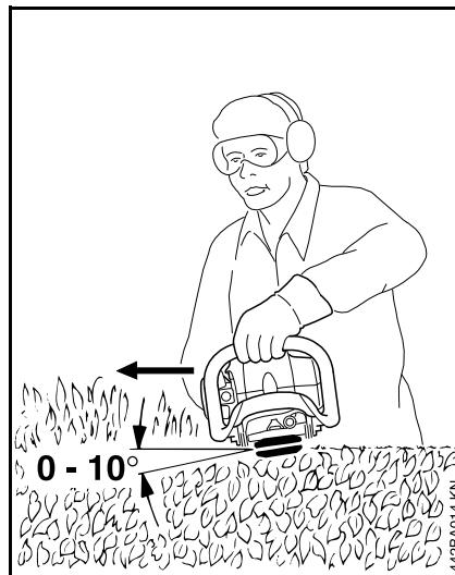
Schneidmesser in einem Winkel von 0° bis 10° ansetzen – aber waagerecht führen.
